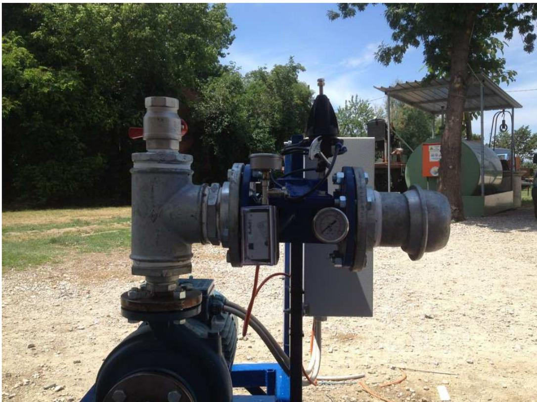
**Elettropompa Caprari ad asse verticale, con pompa a membrana per facilitare il caricamento.**
