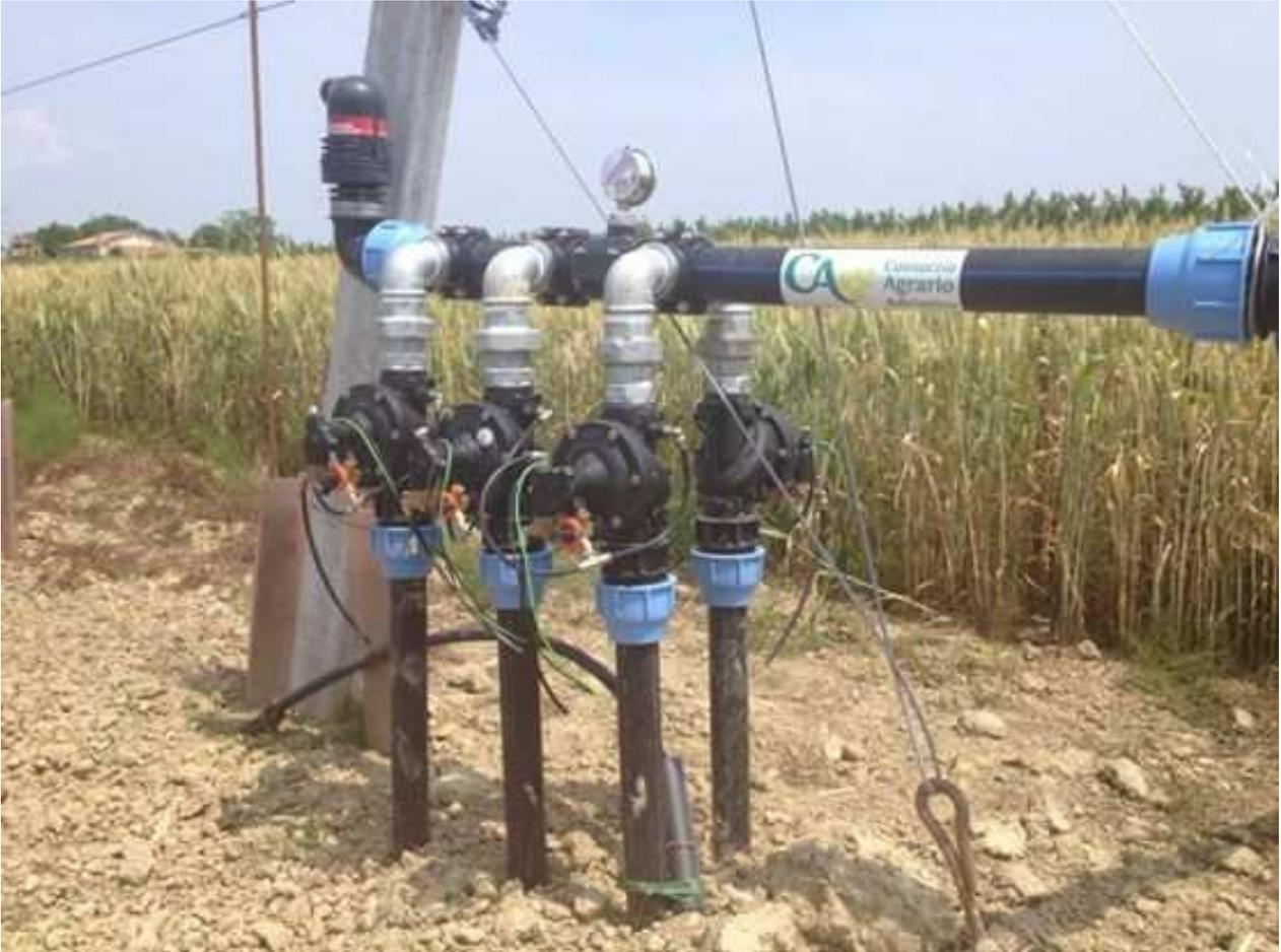
**Idrante di settore con 2 elettrovalvole da 3" 24v – ogni elettrovalvola comanda 3 file di irrigatori super10 ac**
