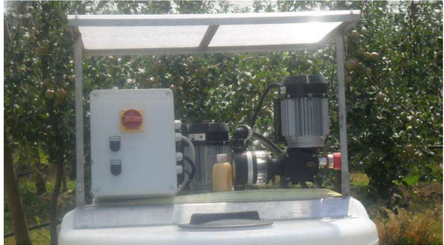
**Kit di fertirrigazione da 1000 L con pompa e agitatore preassemblato in agenzia.**
