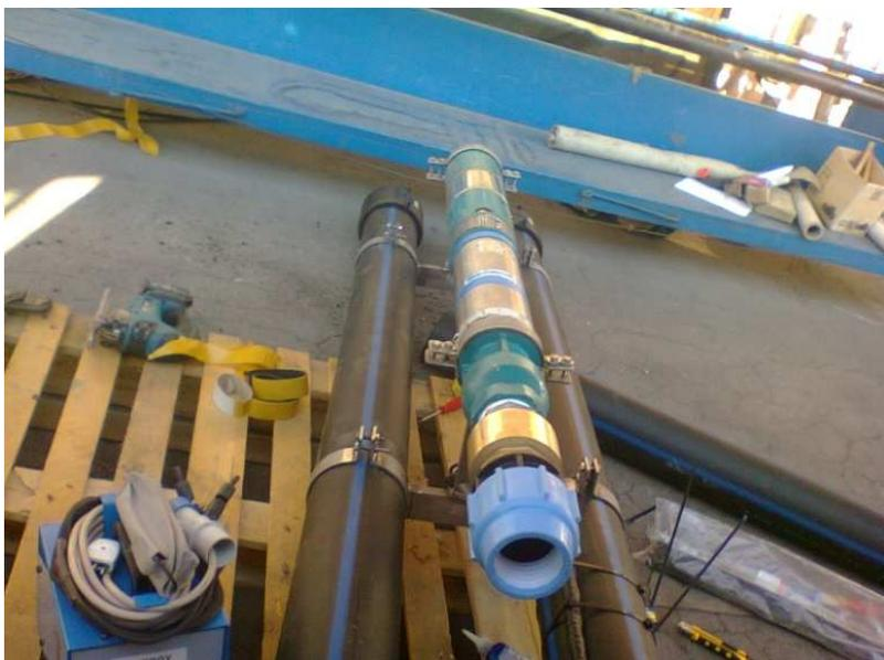
**Elettropompa Calpeda mono girante da 15 HP su telaio con quadro, idrovalvola sostegno pressione e pressostato di minima pressione tutto su cavalletto.**
