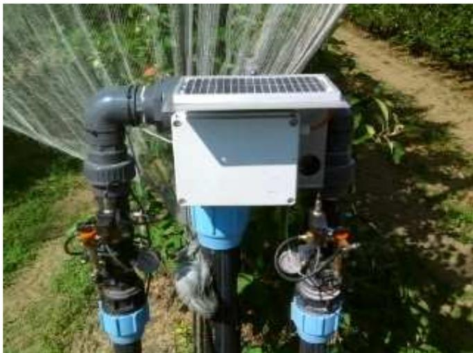
**Valvola settore con ricevitore radio a batteria
