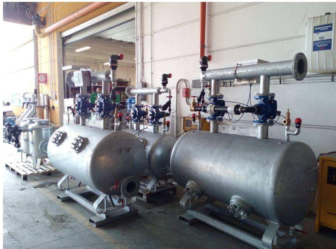
Batteria di filtraggio doppia camera 2x800 con filtro sicurezza a spazzola DN100 e idrovalvola DN100 in sostegno pressione.
